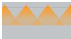
Altoparlanti a debole direttività per una copertura uniforme (vista in sezione)
