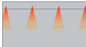
Altoparlanti ad alta direttività creando "punti caldi" e "punti freddi" (vista in sezione)
